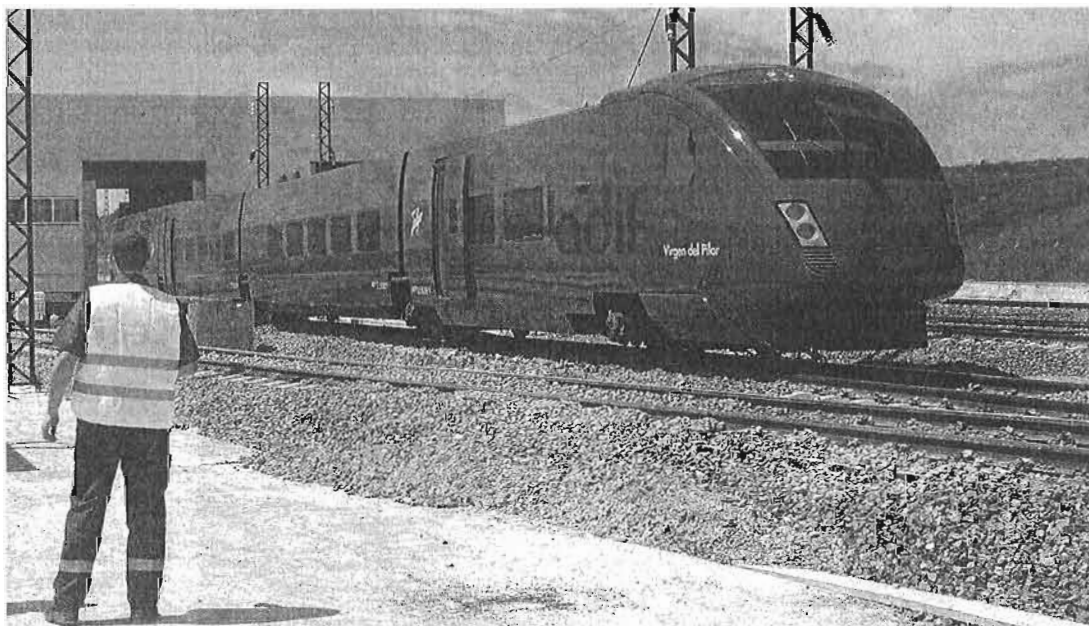
Tren laboratorio de Adif para pruebas en la vía, estacionado en la base de Bobadilla, en Antequera. :: SUR
